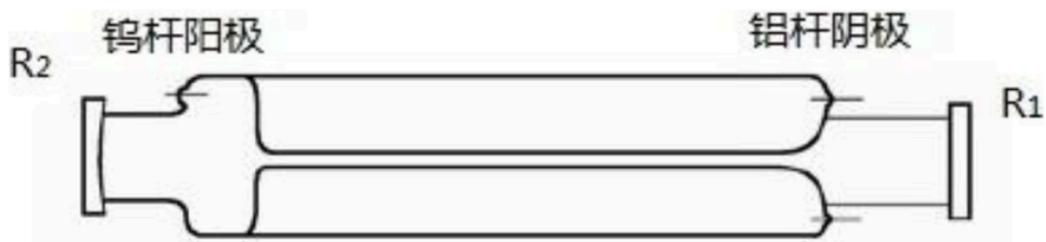
图 2. He-Ne 激光管结构
